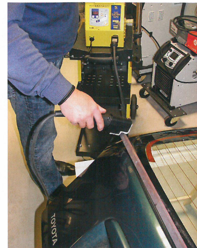
Der Bolzen-Induktor lockert verklemmte Bauteile in Sekunden.
