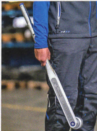
Der neue Drehmoment DNR geht bis zu 760 Nm.
