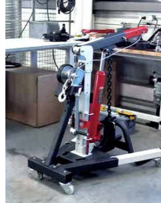
Desde hace tres años, Gys diseña y fabrica sistemas de elevación para talleres de reparación de automóviles/vehículos pesados, con el fin de ayudarlos a manipular cargas pesadas como ruedas y discos de freno. Esta es la zona de pruebas.
