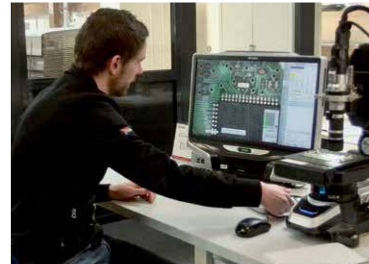
Este microscopio, que aumenta dos mil veces el campo de visión, puede utilizarse, por ejemplo, para comprobar las microsoldaduras de las placas electrónicas.
