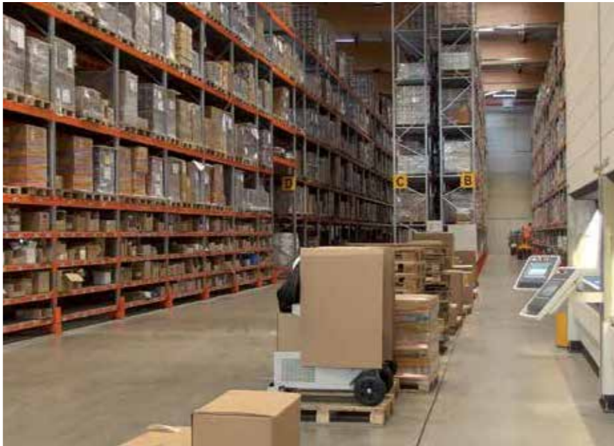
En el almacén, que incluye también estanterías convencionales de 13 metros de altura, se han instalado almacenes verticales dedicados especialmente a los accesorios y consumibles. Los productos pequeños con un alto índice de rotación se almacenan en la zona inferior.
