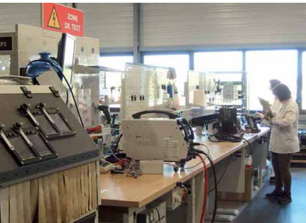
Nell'officina di assemblaggio, ogni linea è organizzata allo stesso modo, con un test di sicurezza elettrica per ogni prodotto alla fine della linea. Una volta convalidato il test, viene emesso un numero di serie con tutte le informazioni di tracciabilità. Questa etichetta viene apposta sul prodotto e sull'imballaggio.
