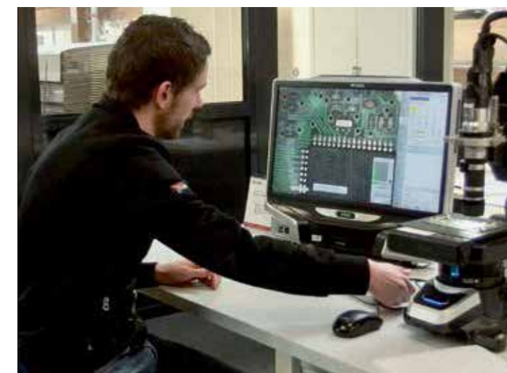
Questo microscopio, che ingrandisce duemila volte, può essere utilizzato, ad esempio, per controllare le micro-saldature sulle schede elettroniche.
