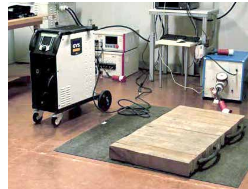
L'area di prova per i prototipi è stata ampliata per snellire il processo tra i progetti dell'ufficio di progettazione e l'avvio della produzione. L'area del pavimento in rame, in cui viene testata l'assenza di disturbi elettromagnetici causati dal generatore, sarà raddoppiata.
