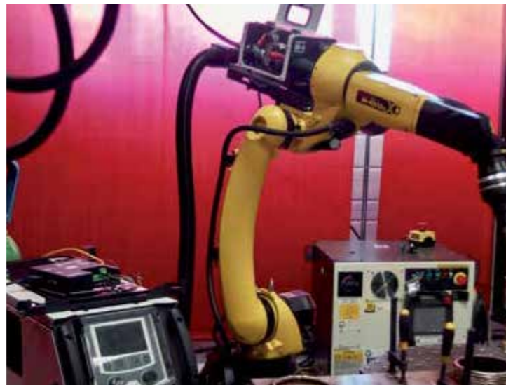
Gys sta progettando l'interfaccia e la scatola di comunicazione tra il robot e il suo generatore di saldatura, oltre al supporto per l'integrazione della scatola nel braccio robotico.
