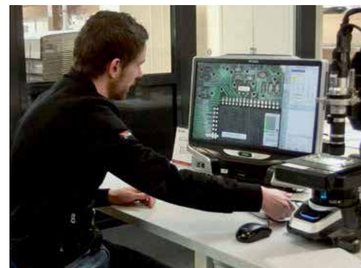
Este microscópio, que aumenta duas mil vezes, pode ser utilizado, por exemplo, para verificar micro-soldas em placas electrónicas.
