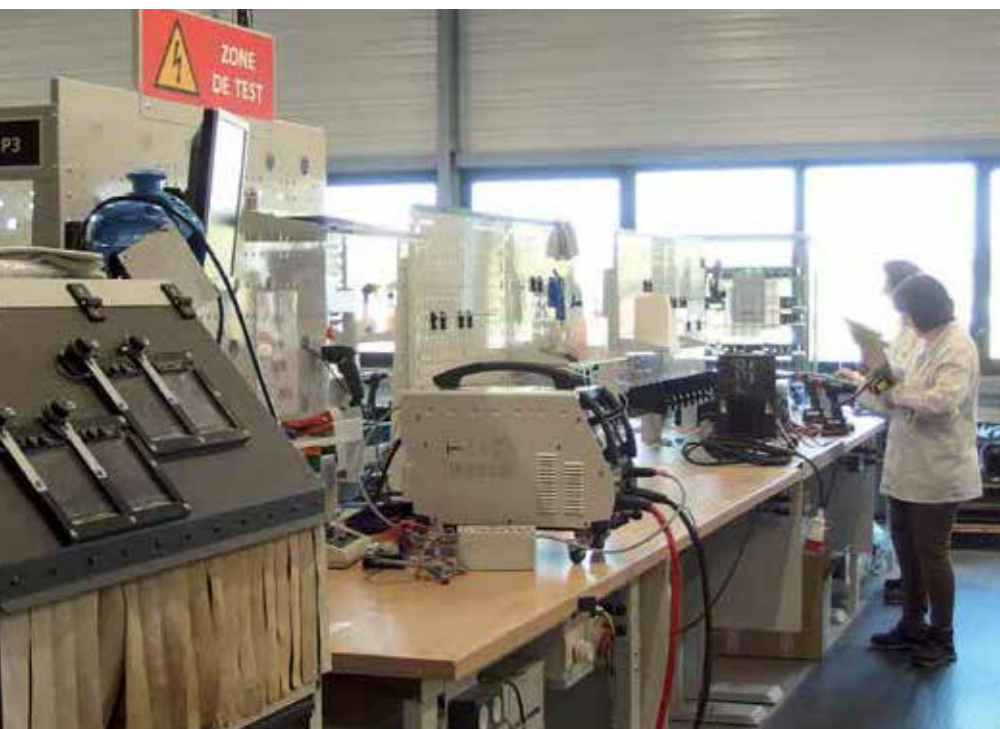
Na oficina de montagem, cada linha é organizada da mesma forma, com um teste de segurança eléctrica para cada produto no final da linha. Uma vez validado o teste, é emitido um número de série com todas as informações de rastreabilidade. Esta etiqueta é afixada no produto e na embalagem.
