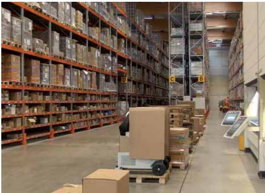
На складе, который также включает обычные стеллажи высотой 13 метров, были созданы вертикальные зоны хранения, предназначенные, в частности, для аксессуаров и расходных материалов. Мелкие продукты с высокой скоростью оборота хранятся в нижней зоне.
