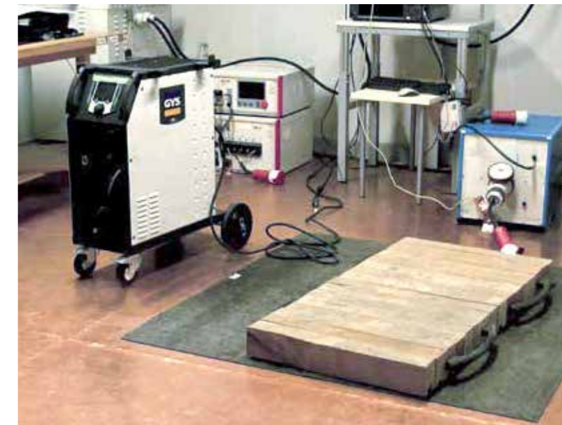
Зона испытаний опытных образцов была расширена, чтобы упорядочить процесс между проектами конструкторского бюро и запуском производства. Площадь этого медного этажа, на котором проверяется отсутствие электромагнитных помех, вызываемых генератором, будет увеличена вдвое.
