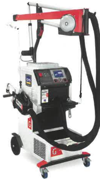
Bis zu 18 Schweißpunkte in der Minute sind mit Gyspot Inverter PTI-G möglich.
