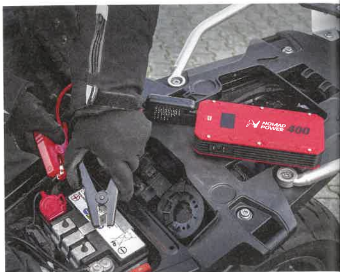
Ein intelligentes Starthilfekabel schützt die Batterie und Fahrzeugelektronik gegen Funkenflug, Kurzschluss, Verpolung sowie hohe Startströme.
