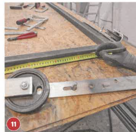
11 Die Position der Befestigungspunkte für die Laufrollen ermitteln (jeweils 10 cm vom Torende) und anzeichnen.
