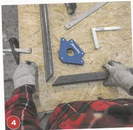
4 Die Rohre für einen Rahmen auf der Arbeitsfläche auslegen. Die Eckstöße mit einem 90°-Schweißmagneten fixieren.
