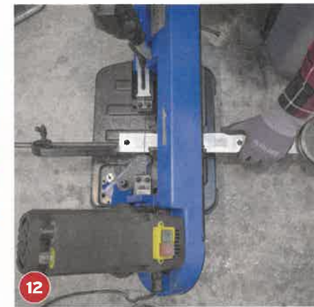
12 Die Bänder der Laufrollen einkürzen (hier: 48 cm). Die Rollen sollen später satt auf der Schiene aufliegen.
