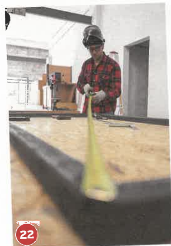
4 Die Rohre für einen Rahmen auf der Arbeitsfläche auslegen. Die Eckstöße mit einem 90°-Schweißmagneten fixieren.
