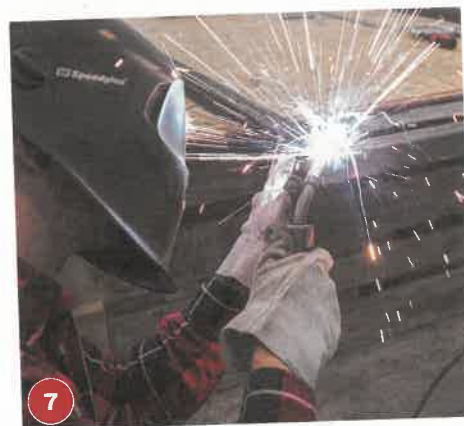
7 Ist der Rahmen rechtwinklig, können die Rohre an den Ecken miteinander verschweißt werden.
