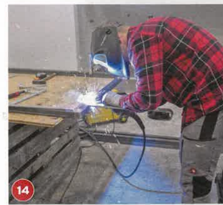
14 Die angehefteten Laufrollen von beiden Seiten sorgfältig anschweißen. Die Nähte halten den Torflügel in Position.
