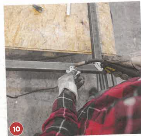
10 Die kleinen Bockrollen heftet man auf die Rohrecken an der Unterseite der Rahmenrückseite (10 cm vom Rand).
