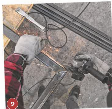
9 Nach dem Schweißen werden alle Unebenheiten an den Nähten mit dem Winkelschleifer glattgeschliffen.
