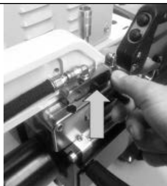
2. Levantar la palanca D para desbloquear el brazo.
