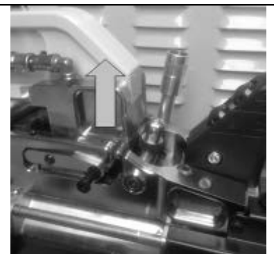
3. Desplazar el brazo hacia atrás y levantarlo para quitarlo del soporte.
