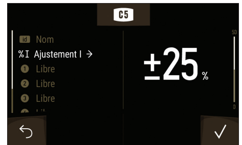
Consente di regolare l'impostazione aggiuntiva della corrente (Reg I) da 0 a 50%.
