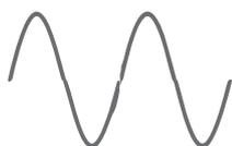
**PSW (Pure Sine Wave)** : les modèles PSW délivrent une tension stable, de même qualité qu'un réseau électrique. Ils peuvent alimenter tous les appareils, même les plus sensibles (néon, télévision, ordinateur fixe, etc).
