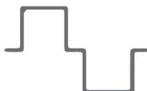
**MSW (Modified Sine Wave)** : Les modèles MSW génèrent une onde alternative modifiée. Ils sont adaptés pour recharger la plupart de l'électroménager et des appareils électroniques tels que les téléphones, appareils photo, ordinateurs portables, éclairage ...
